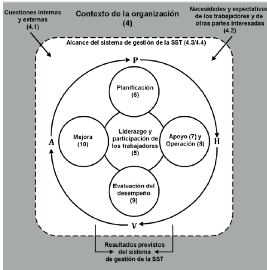
Figura 1. Relación entre el PHVA y el marco de Referencia de la Norma ISO 45001:2018.
