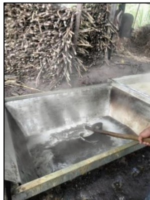
Ilustración 18: Proceso de calentamiento del jugo de caña y retiro de cachaza, molienda vereda San Cayetano-Caparrapí-Cundinamarca.
