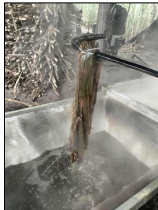
Ilustración 17: Proceso de aplicación del guásimo al jugo de caña, molienda vereda San Cayetano-Caparrapí-Cundinamarca.
