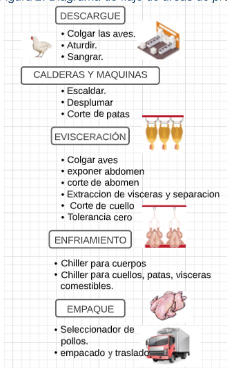
Figura 2. Diagrama de flujo de áreas de procesamiento en planta de beneficio avícola
