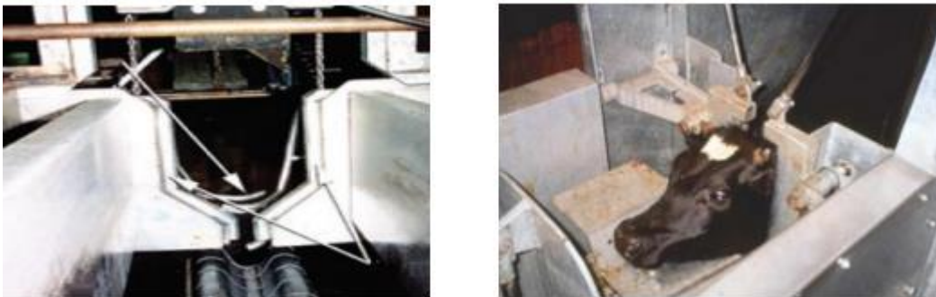
Figura 2. Sujetadores de cabeza del cajón de aturdimiento en bovinos a) Sujetador pasivo (FAO, 2007), (b) sujetador activo. Tomado de: Grandin, (2010).
