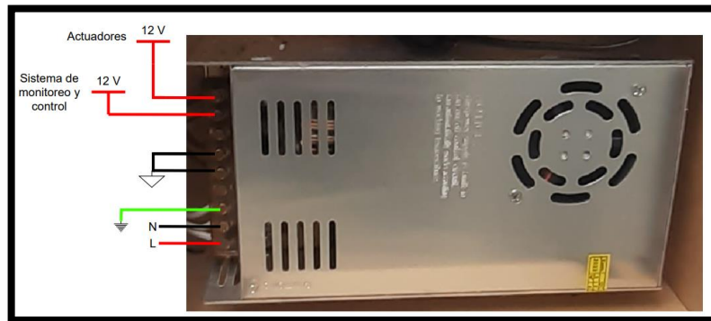
Ilustración 40. Diagrama alimentación eléctrica diseño experimental.
