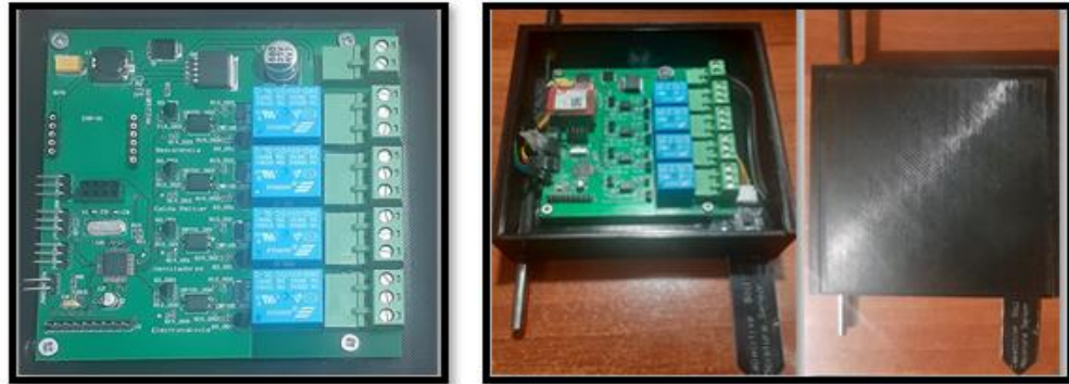
Ilustración 43. Ensamble sistema de monitoreo y control.
