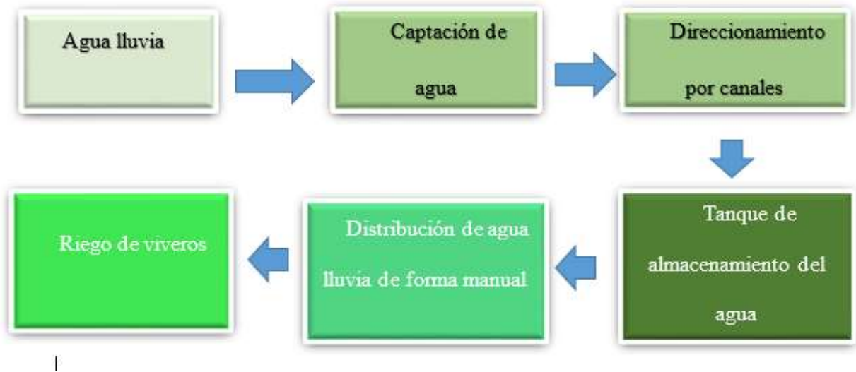
Figure 8. PROCESO ACTUAL DE LA CAPTACIÓN DEL AGUA.
