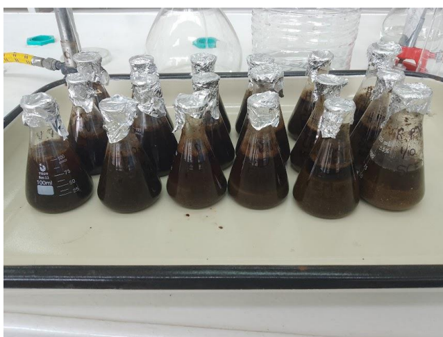
Figura 1. Reactores con digestión anaerobia
