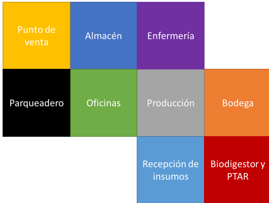
Ilustración 30 Diagrama adimensional de bloques, distribución de áreas para el diseño de planta 2 Fuente: Elaboración propia.
