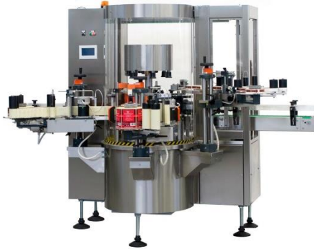
Ilustración 27 ETIQUETADORA AUTOMÁTICA B2TRIC B2T6RIC Fuente: Boada Tecnología Ibérica, 2023
