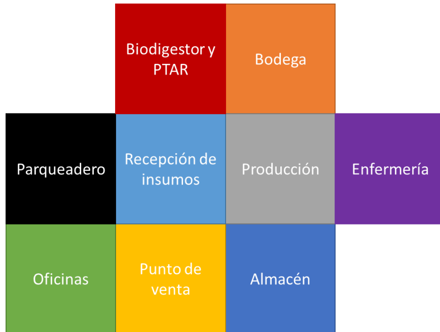
Ilustración 34 Diagrama adimensional de bloques, distribución de áreas para el diseño de planta 4 Fuente: Elaboración propia.
