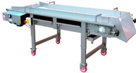
Ilustración 20 MESA DE SELECCIÓN CON CINTA TRANSPORTADORA TS80040 Fuente: Boada Tecnología Ibérica, 2023
