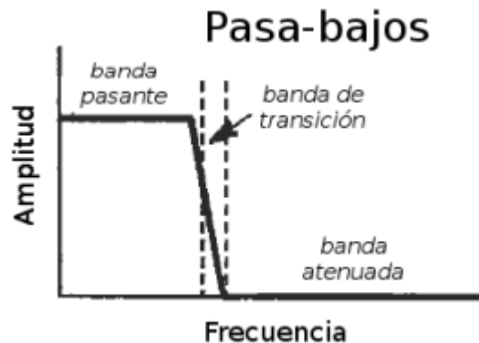
Figura 8. Respuesta ideal y real de un filtro pasa bajas (Smith, 2011).
