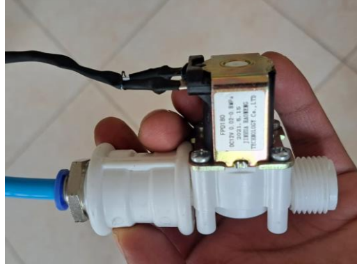
Ilustración 74. Válvula Solenoide salida tanque condensado.
