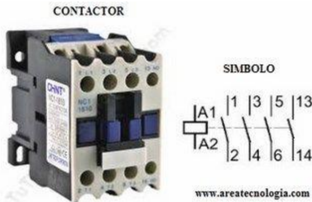
Ilustración 53. Contactor y conexiones, según nomenclatura.
