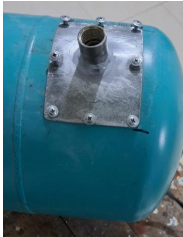
Ilustración 40. Lamina para sellar y conexión de unión 1/2" Inox
