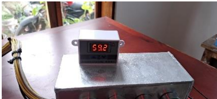
Ilustración 59. Controlador de temperatura en Funcionamiento.
