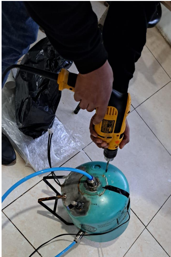
Ilustración 29. Ajuste del tanque para evaporar agua, se agrega resistencia eléctrica sumergible.
