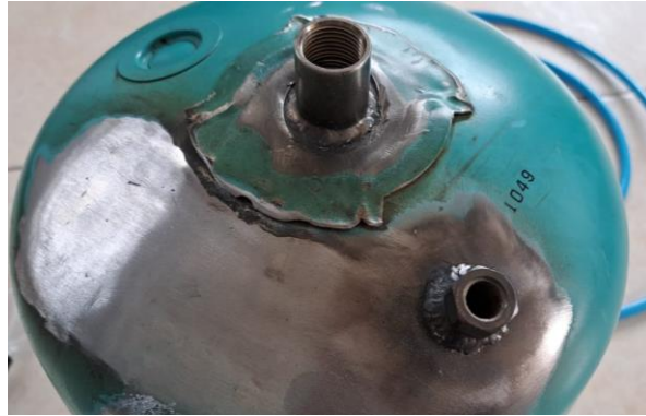
Ilustración 28. Perforación y soldadura de Uniones para entrada y salidas
