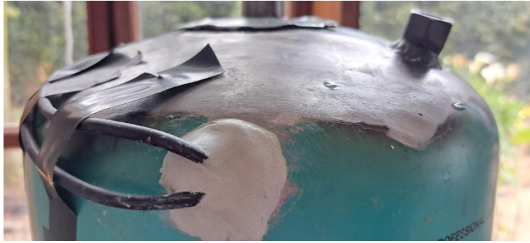
Ilustración 35. Sellado de orificio de conexión eléctrica.
