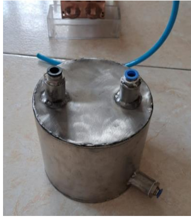
Ilustración 46. Tanque de almacenamiento de condensado.
