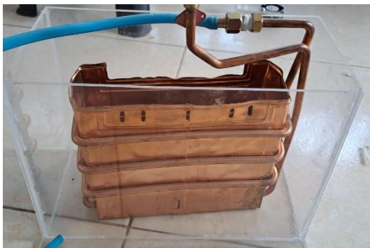
Ilustración 44. Serpentín - Intercambiador de Calor en este proyecto.
