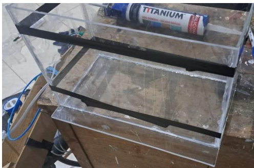
Ilustración 26. Tanque de Condensado, construcción con elementos reciclados.
