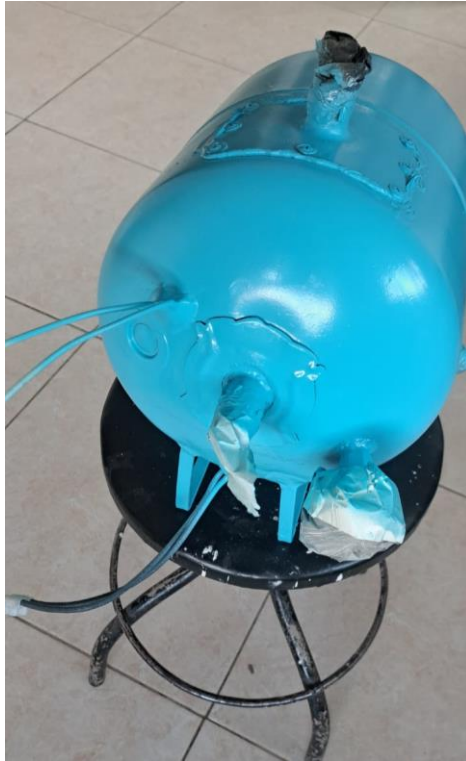
Ilustración 48. Tanque de evaporación, ajuste final conexiones y pintura.
