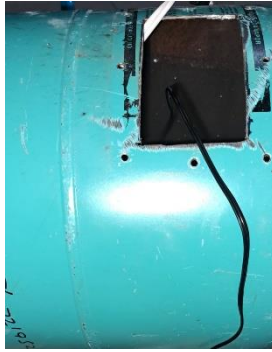
Ilustración 37. Perforación para Ingresar la resistencia eléctrica.
