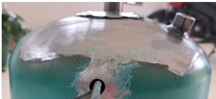
Ilustración 34. Perforación para Instalar la resistencia eléctrica.
