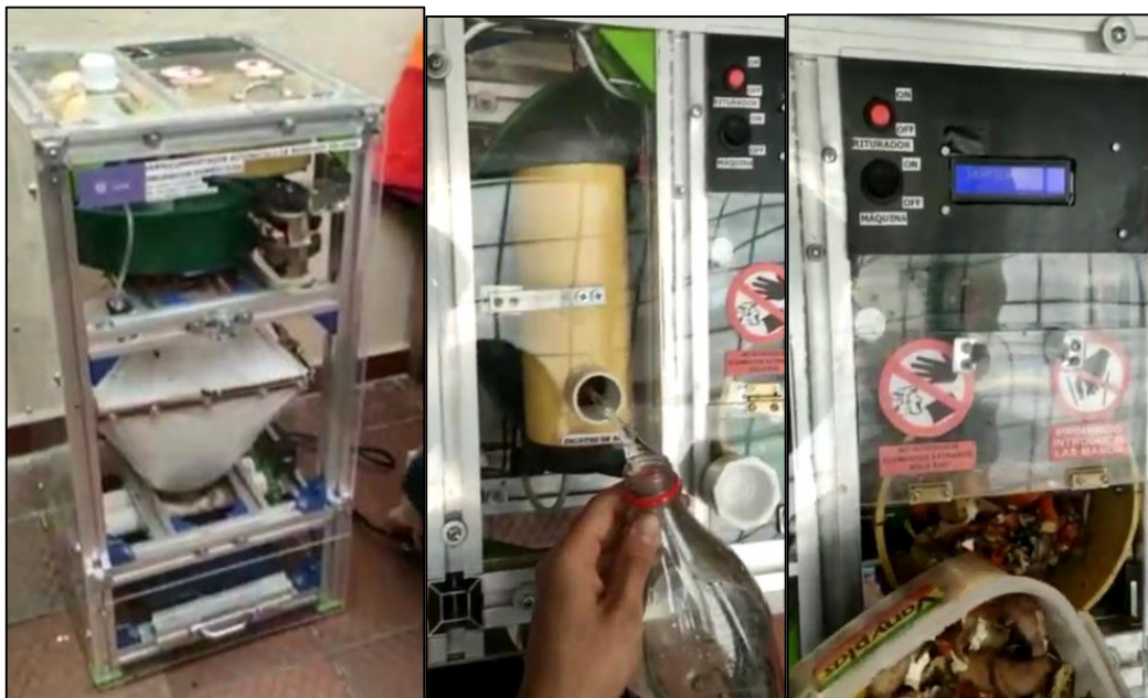
Figura75. Máquina procesadora de residuos orgánicos. Fuente: Propia
