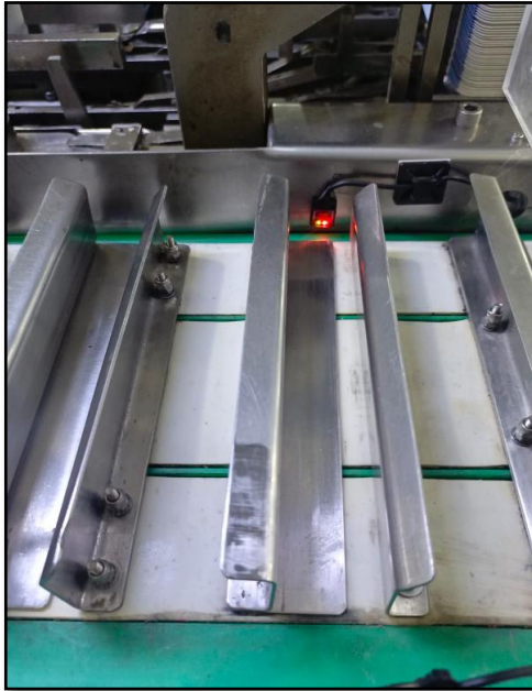
Figura 23. Sensor de Detección de Tubo
