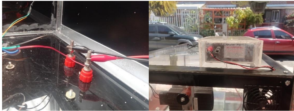
Ilustración 63 Conexión fuente alto poder
