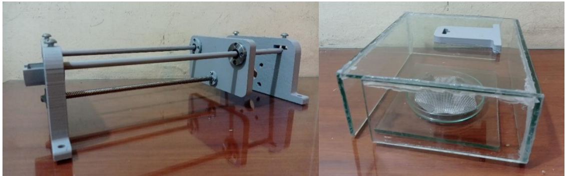
Ilustración 50 Sistema inyector y colector construidos
