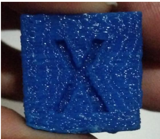
Ilustración 51. Cubo XYZ análisis de la superficie.
