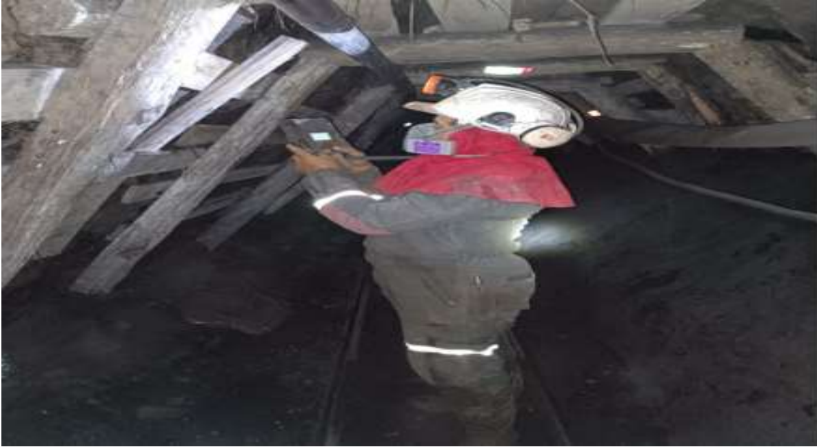
Figura 2. Inspección medición de gases.
