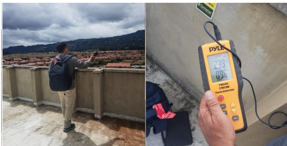
Ilustración 1 Mediciones con el anemómetro de velocidad de viento en el centro comercial. Fuente propia
