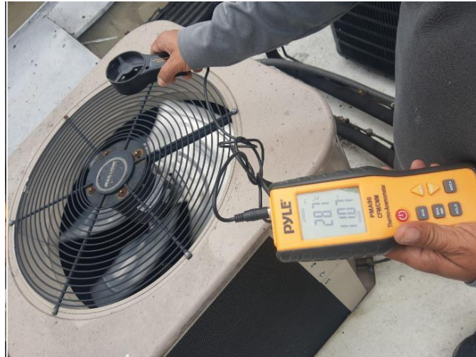
Ilustración 2 Medición de velocidad en la parte superior de un condensador de aire acondicionado vertical
