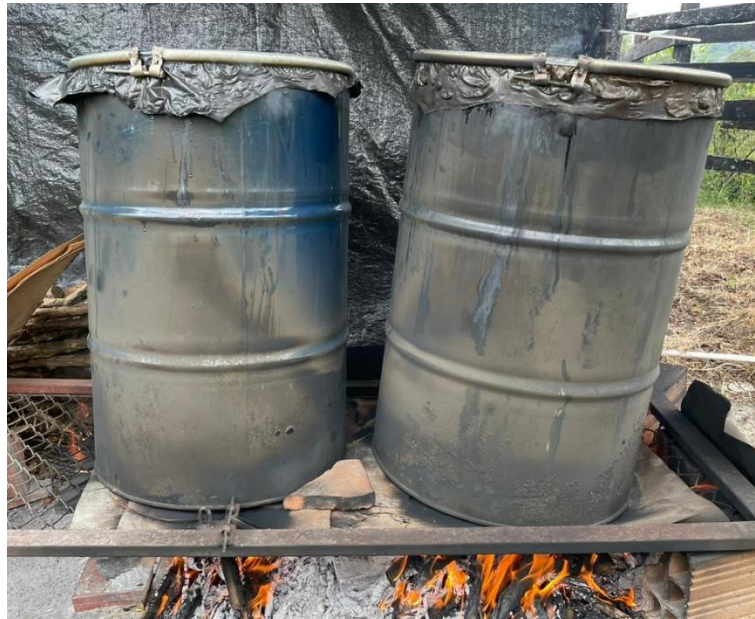
figura 21. Uso de canecas metálicas para realizar el proceso de pasteurización. (Propia).
