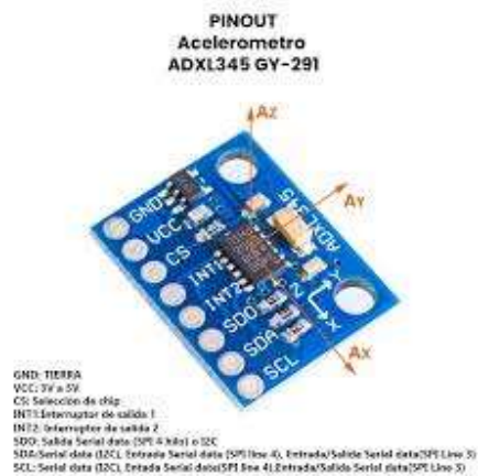
Figura 20 Datasheet del ADXL345 con sus respectivos entradas y salidas
