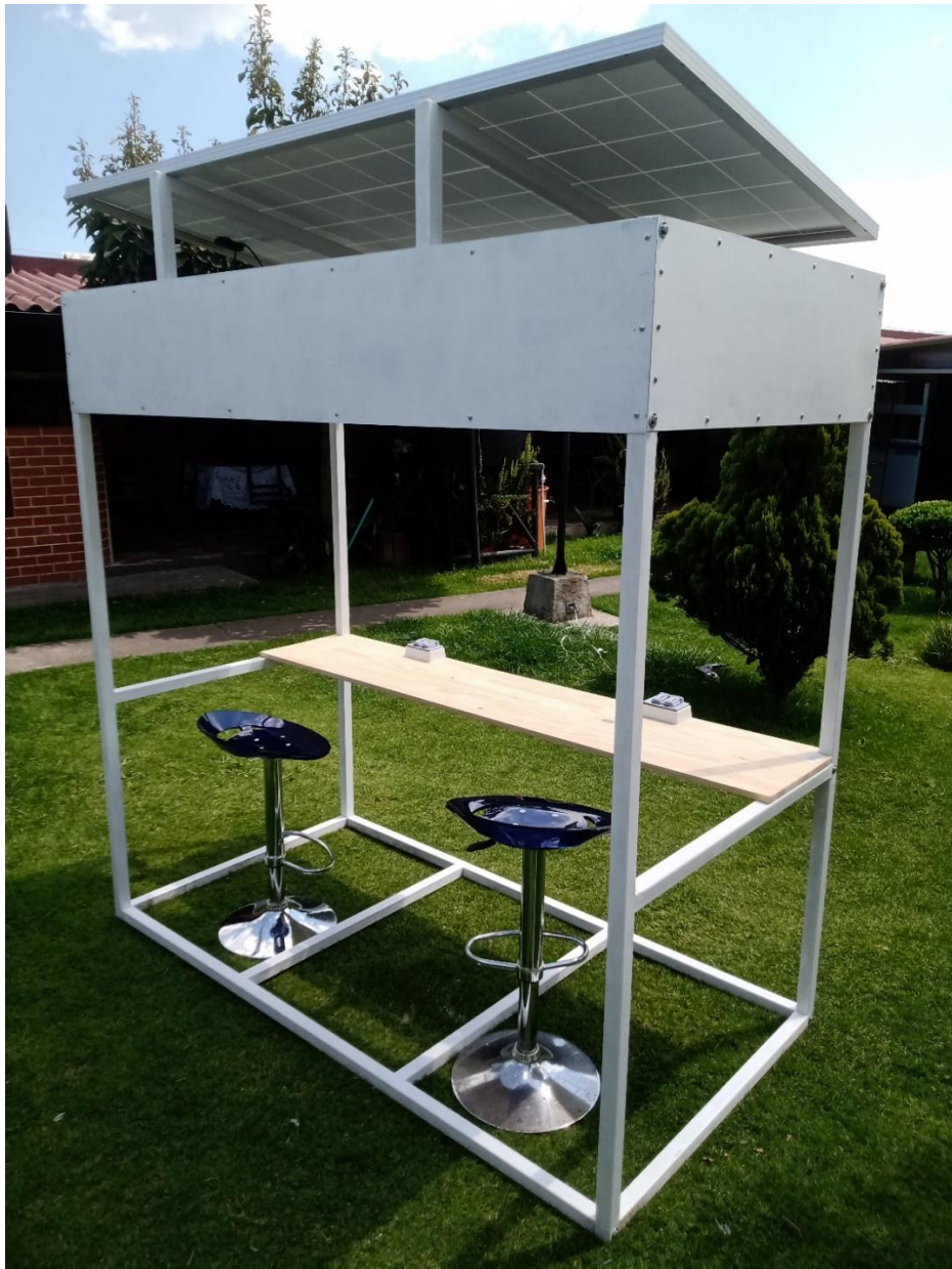
Figura 116. Estación de carga ensamblada.
