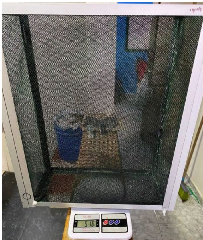
Figura 92. Malla ensamblada en módulo de recolección.
