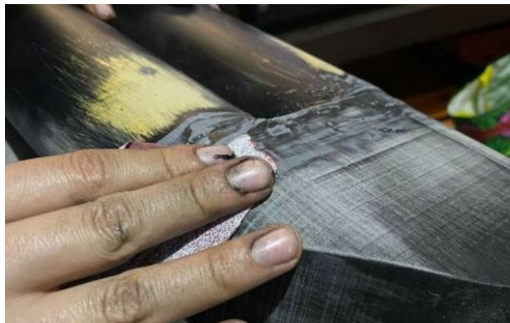
Figura 96. Proceso de limado y acople de tapones en cascos.
