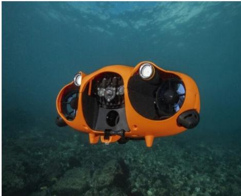
Figura 24. Robot acuático impulsado por sistema de turbinas.
