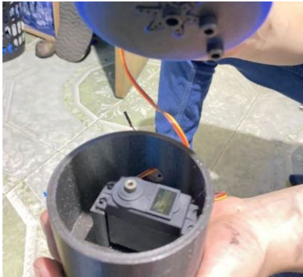
Figura 97. Ensamble de servomotores.
