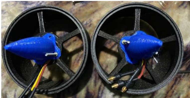
Figura 95. unión de motor & turbina.
