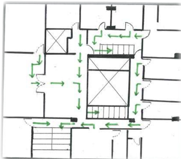
Figura 4. Ruta de evacuación planta 3.
