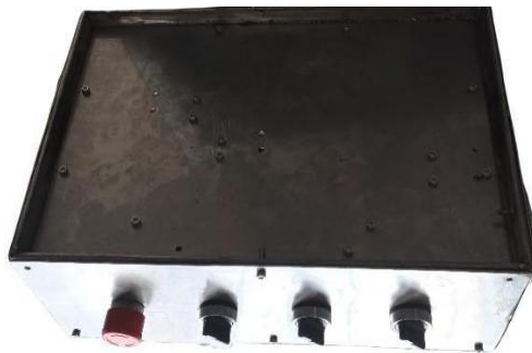
Figura 59. Ensamble tablero de mandos a estructura.
