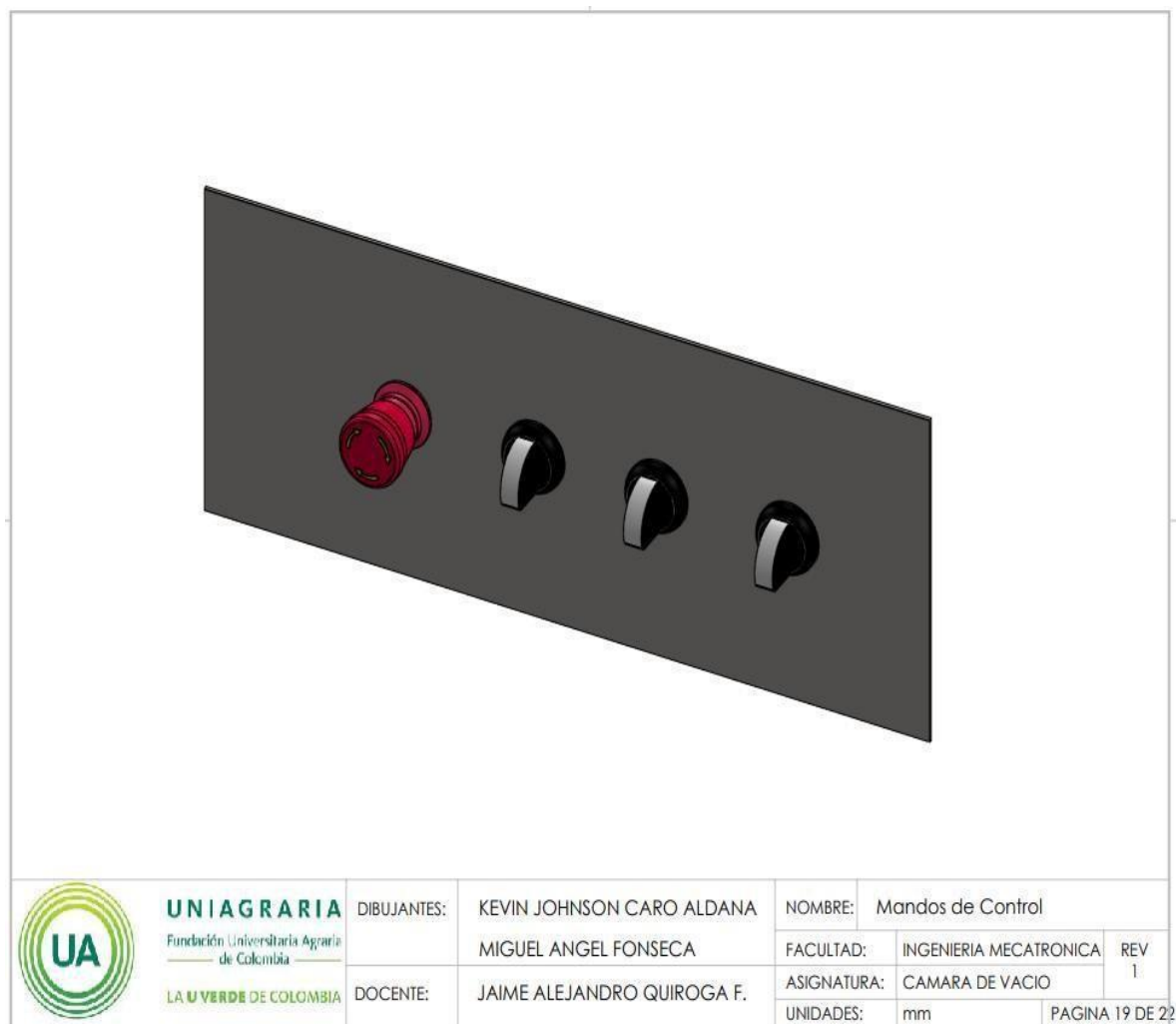
Figura 52. Tablero mandos de control.
