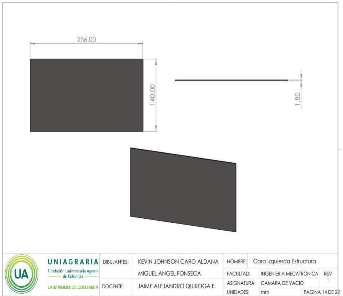
Figura 47. Cara izquierda estructura.
