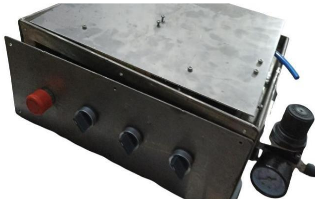
Figura 60. Ensamble estructura con sistema neumático.
