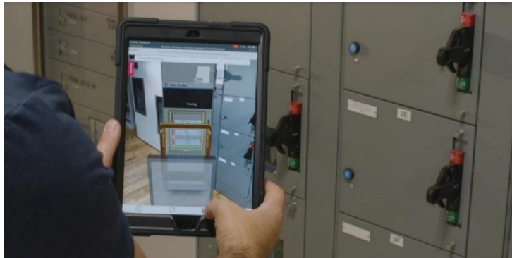
Figura 74. Tablet que implementa la realidad aumentada para el mantenimiento de una unidad.
