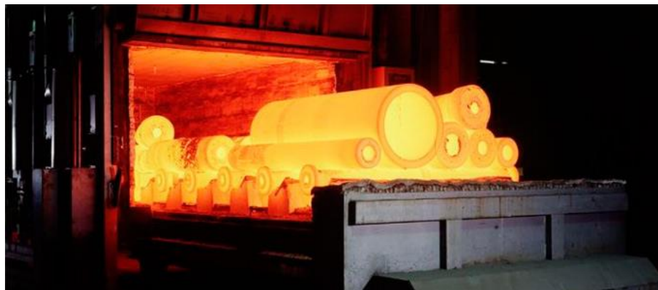
Figura 44. Tratamiento térmico de piezas de metal.
