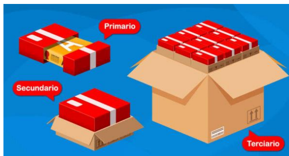
Figura 55. Los 3 procesos básicos de empaquetado.
